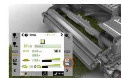
POWER FEEDING SYSTEM je snadno reverzovatelný z kabiny.
