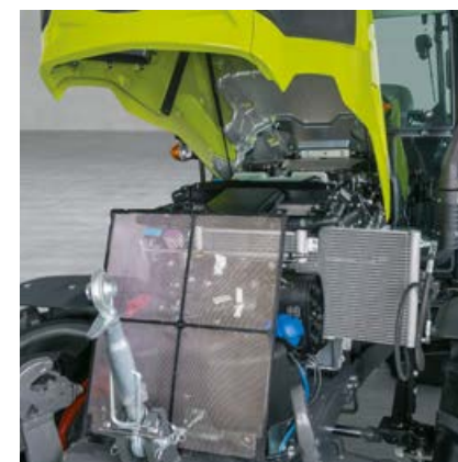
Ve vteřině také odklopite chladič a vyjmete sito pro kontrolu a čištění.
