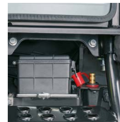
AXOS 200 Vám usnadňuje každý den spoustou inteligentních řešení, jako je např. přemístění polů baterie na pravou stranu kabiny.
