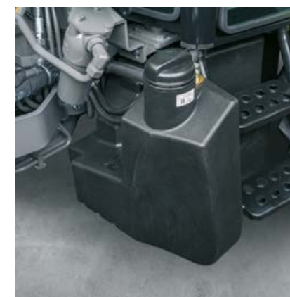
105 l palivová nádrž a 10 l nádrž na močovinu nabízí dostatečný dojezd i při dlouhých a intenzivních pracovních dnech.
