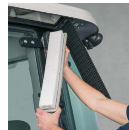
Vzduchový filtr kabiny je pro čištění snadno přístupný zvenku a zajišťuje vždy svěží klima v kabině.
