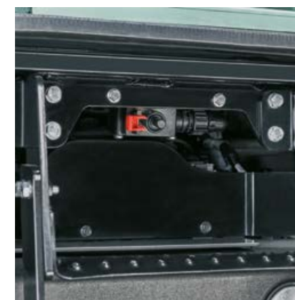
Odpojovač baterie je umístěn na dosah ruky na levém vstupu.
