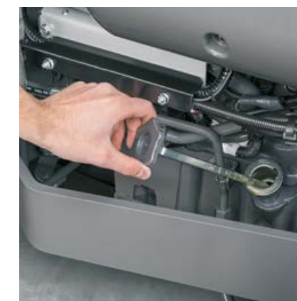
Kontrola oleje a doplňování se provádí při zavřené kapotě na pravé straně traktoru AXOS 200.
